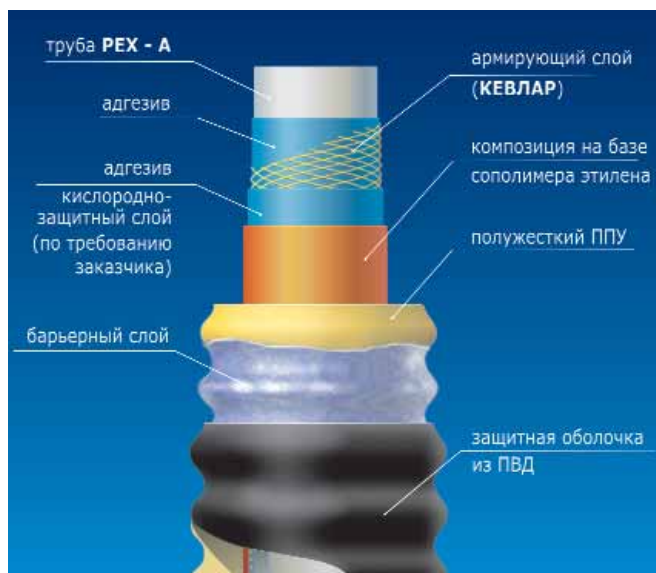
Рис. 1. Конструкция гибкой трубы «Изопрофлекс-А»
